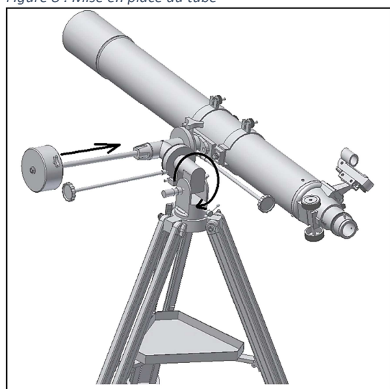
Figure 10 : Équilibrage de l'axe A.D. du tube du télescope
