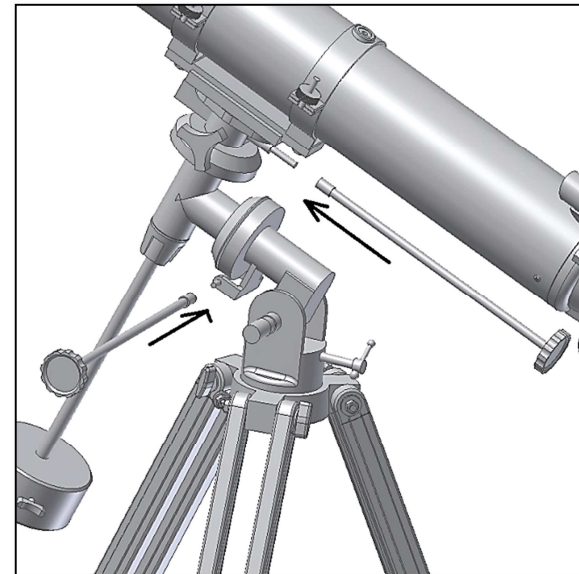
Figure 7 : Mise en place et fixation des deux tiges, A.D et de déclinaison
